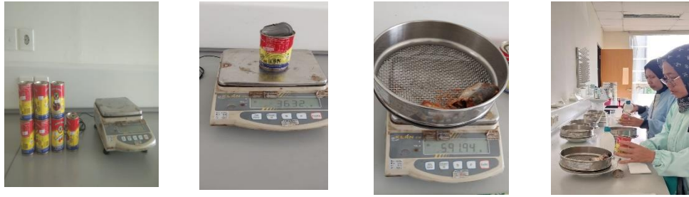
Gambar 88. Mackarel in Tomato Sauce kaleng dengan metode pengujian penentuan berat bersih dan bobot tuntas produk perikanan sterilisasi komersial RSNI3 2372-8:2019
