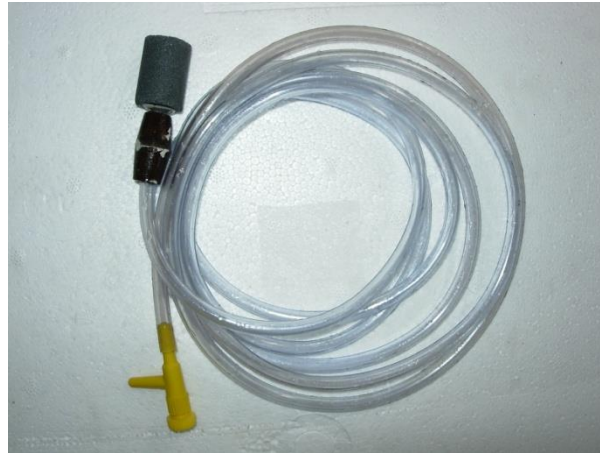
Gambar 18. Selang, Regulator, dan Batu Pemberat Aerasi
