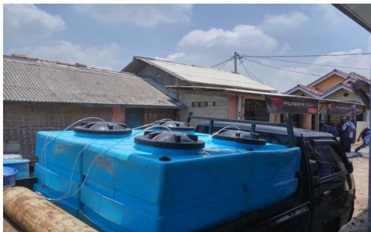
**Gambar 16. Mobil pengangkut ikan hidup, dilengkapi bak dan oksigen**
