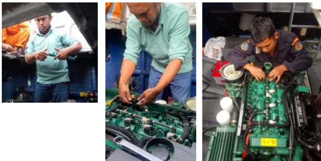
Gambar 11. Penggantian Overflow dan sensor BBM KP. Speedboat Napoleon 028
