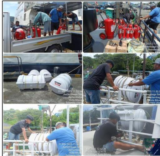
Gambar 10. Kegiatan perawatan kapal pengawas berupa perbaikan perlengkapan keselamatan dan pemadam kebakaran KP Orca 04
