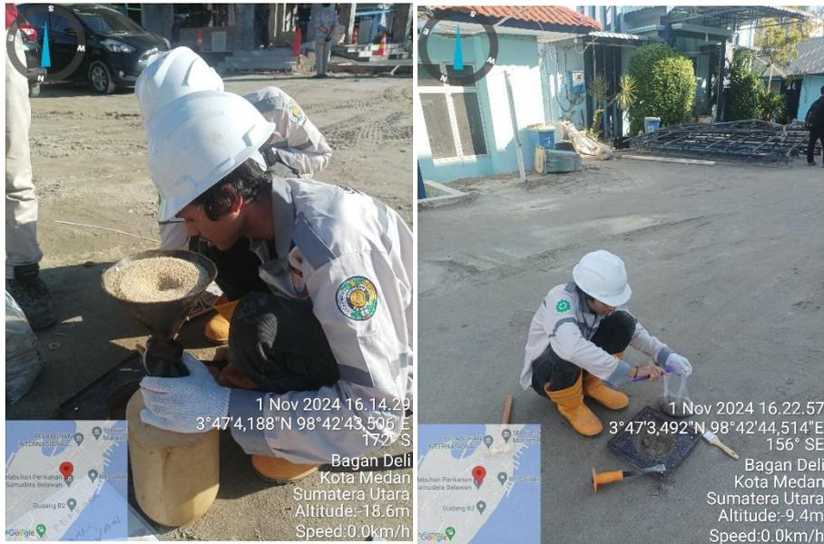
**Gambar 14. Pengujian Kepadatan Tanah Timbunan**
